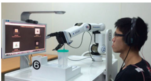
餵食機器人：與鴻海公司合作並技轉，內含腦波控制、機器手臂手掌控制、影像處理與人機介面等技術，展示照護科技與精神。
