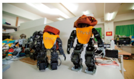
人型機器人：可完成整體隊形與運動或跳舞之動作展示，訓練機器人入門之基本能力，朝向智慧型機器人之研究發展。
